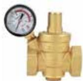
Le régulateur de débit de pression permet de réduire la pression de l'eau qui alimente un bâtiment. Il est positionné après le compteur d'eau de la régie concernée et en amont du réseau hydraulique.
