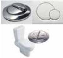
Les toilettes à chasse d'eau à double débit permettent d'adapter la quantité d'eau de rinçage de la cuvette en fonction du besoin : 3 à 4 litres d'eau pour un petit rinçage, 6 à 9 litres pour un grand rinçage avec la possibilité d'interrompre le débit. Cela permet d'économiser considérablement la consommation d'eau.
